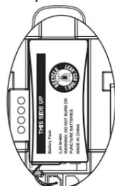
③ Glissez le couvercle du compartiment vers le centre du combiné, jusqu'à ce qu'il se verrouille en place.
