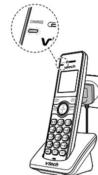
Lorsque vous avez installé la pile, l'affichage ACL indiquera le statut de la pile (voir le tableau ci-dessous).
